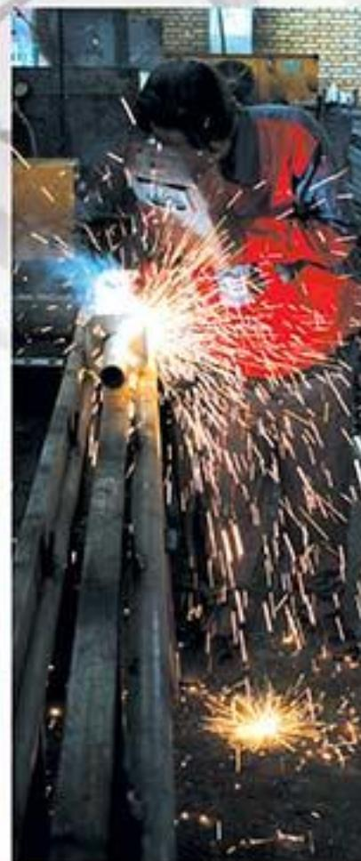
در فرایند تولید زودبست جوش از اهمیت بسیاری برخوردار است، استفاده از سیستم جوش ۲ موجب افزایش مقاومت اتصالات و دوام و استحکام قطعات می‌گردد. همین دلیل کلیه جوش‌ها دارای سیستم ۲ می‌باشد و کنترل استحکام جوش به روی کلیه قطعات انجام می‌گردد.
